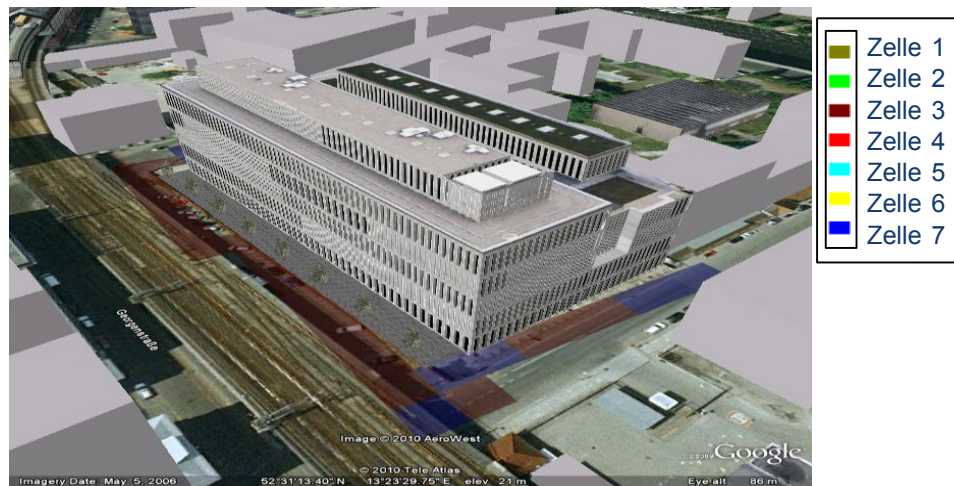
Abbildung 9-9: Beispielhafte Best Server um ein Objekt, Pixelgröße 8 Meter (Quelle: Google)
